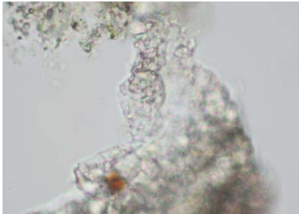
Matériau isotrope observé dans l'échantillon 100614.04p Dispersion en microscopie optique, largeur ~ 85 µm
