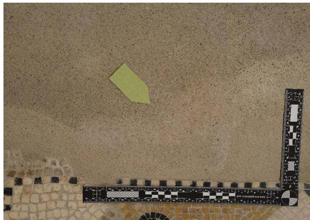
Figure 12 : Voile blanc observé sur le mortier de restauration de la mosaïque n°7. ©HE-Arc CR, 2015.
