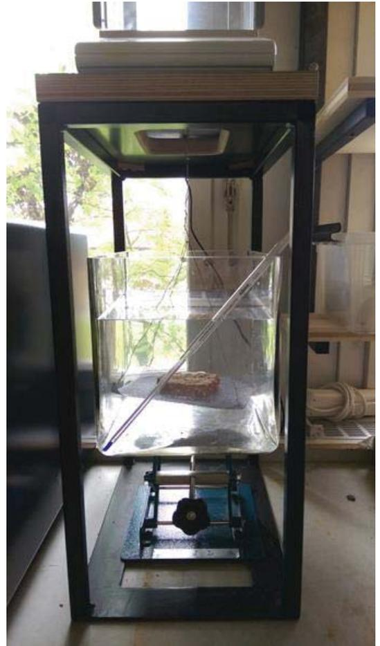
Figure 44 : Mesure du poids des échantillons dans un panier en métal plongé dans l'eau, crocheté à une balance. ©HE-Arc CR, 2015.
