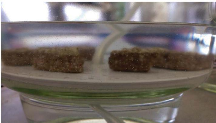
Figure 43 : Imbibition en eau dégazée des échantillons de mortier sous vide. ©HE-Arc CR, 2015.
