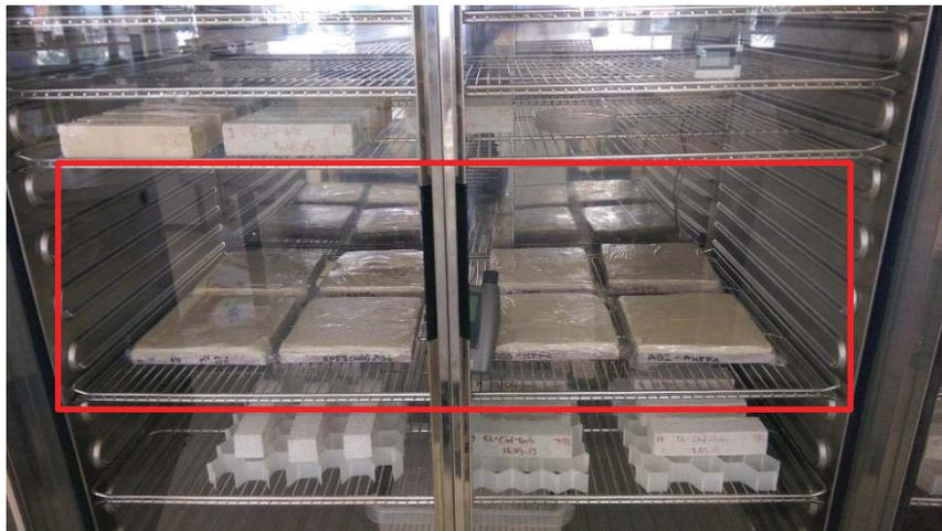
Figure 35 : Planelles recouvertes de compresses installées dans l'armoie climatique. ©HE-Arc CR, 2015.
