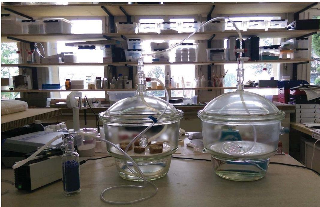
Figure 45 : Installation de mise sous vide des échantillons afin des les imbiber d'eau dégazée. ©HE-Arc CR, 2015.
