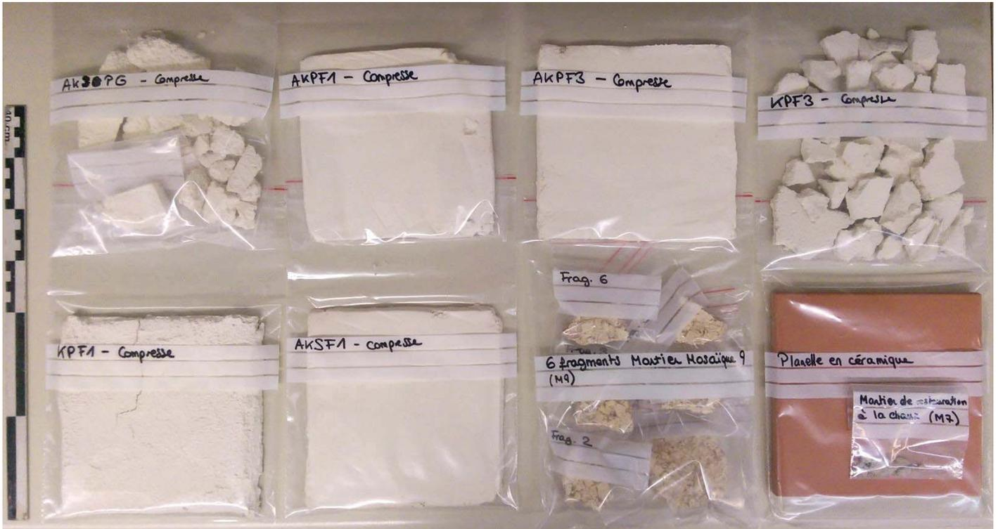
Figure 39 : Echantillons pour les analyses de porosimétrie. ©HE-Arc CR, 2015.
