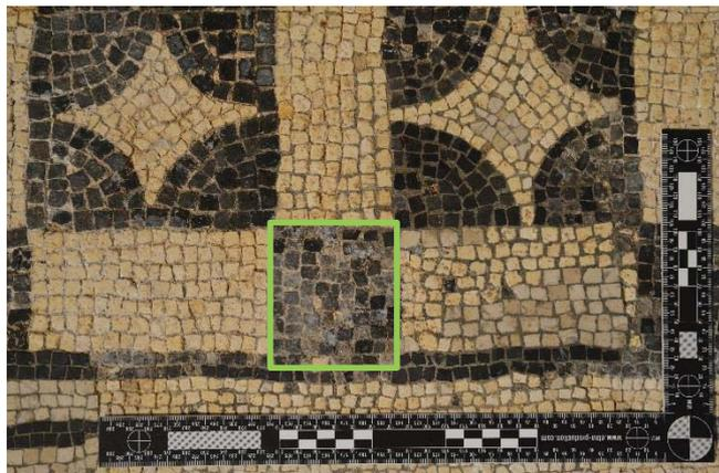
Figure 11 : Whiskers observés en surface de la mosaïque n°8 (dans le carré vert). ©HE-Arc CR, 2015.
