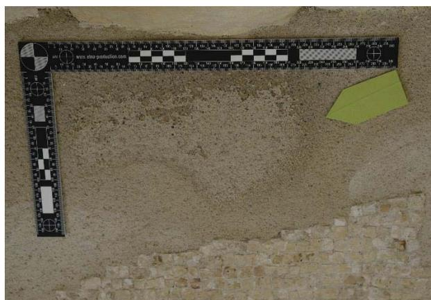
Figure 14 : Croûte observée sur le mortier de restauration de la mosaïque n°7. ©HE-Arc CR, 2015.
